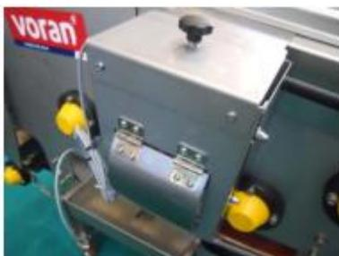
**Système de capteur sur bac élévateur broyeur
